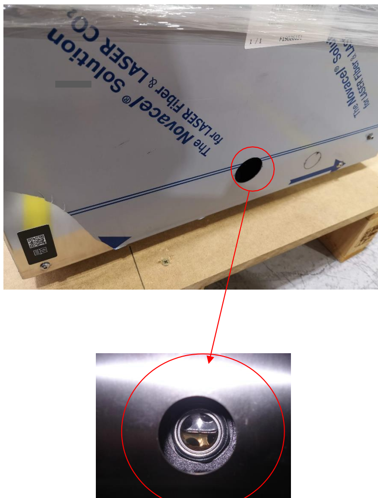
Ilustracja 1. Otwór poglądowy do kontroli poziomu oleju
