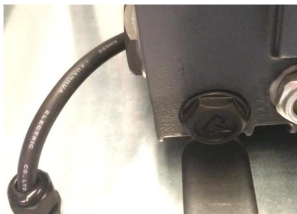
Ilustracja 5. Wymontować korek spustowy oleju
