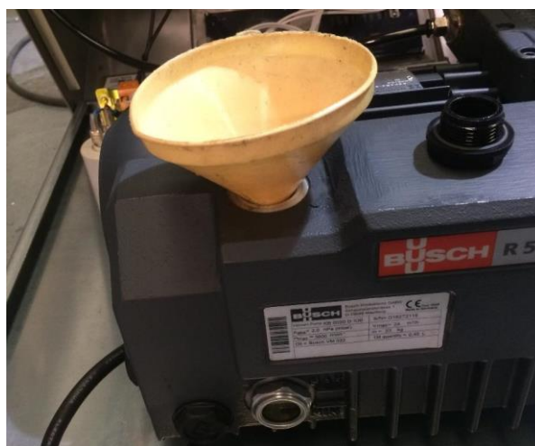
Ilustracja 7. Odkręcić korek wlewu oleju i wlać nowy olej
