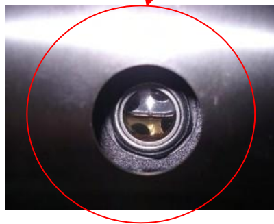
Ilustracja 1. Widok z tyłu do sprawdzania poziomu oleju.
