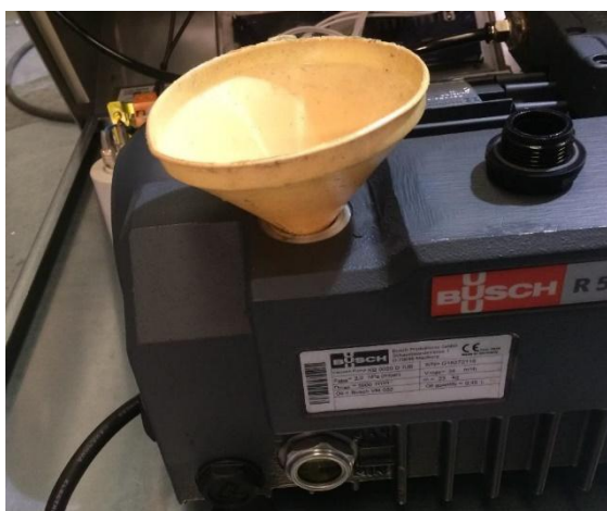
Ilustracja 6. Wykręcić korek wlewu oleju i wlać nowy olej
