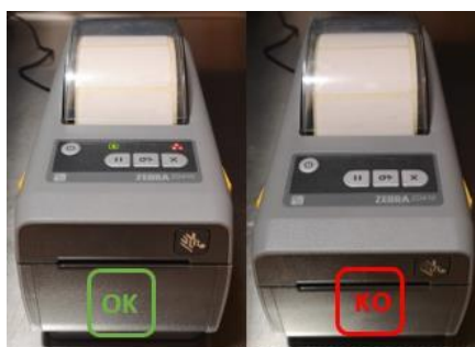
Rysunek 13. Sprawdzanie podłączenia drukarki
