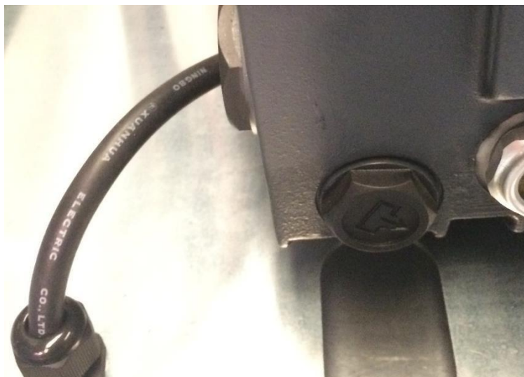
Ilustracja 4. Wymontować korek spustowy oleju
