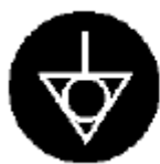
UZIEMIENIE INSTALACJI ELEKTRYCZNEJ
