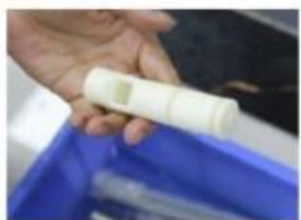
Oczyścić głowicę tłoczącą i uszczelka D
