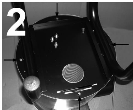
PUNKT WYJŚCIA: WYJĄĆ 4 ŚRUBY M8 WSKAZANE STRZAŁKAMI
