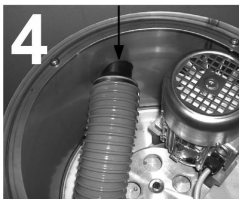
ZGIAĆ GIĘTKĄ RURĘ, ABY WSUNĄĆ JĄ NA OTWÓR, JAK POKAZANO NA ZDJĘCIU, ZŁOŻYĆ PONOWNIE PODSTAWĘ PRZYKRĘCAJĄC 4 ŚRUBY M8
